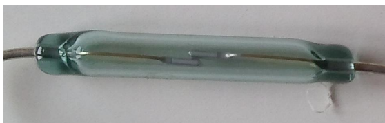
Abb. 36: Detailaufnahme des Reedkontaktes
