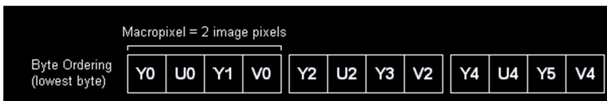
Abb. 4: Byte-Reihenfolge im YUY2-Format (YUV 4:2:2). U entspricht Cb, V entspricht Cr (Quelle: http://www.fourcc.org/yuv.php )
