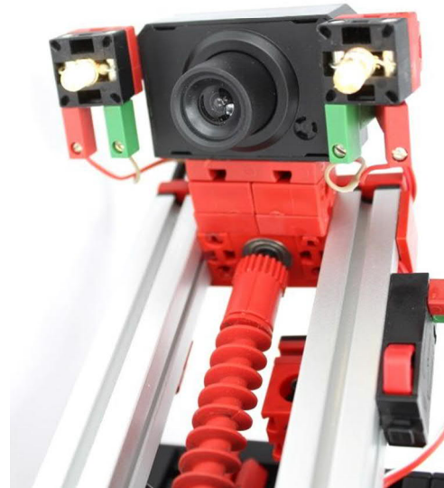
Abb. 10: Kamera mit Endlagenschalter
