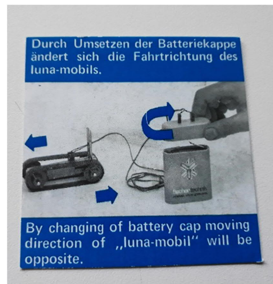
Abb. 2: Batteriekappe für Flachbatterien
