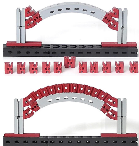
Abb. 9: Oben das Lehrgerüst und die Bausteine, unten der Bogen im Rohbau
