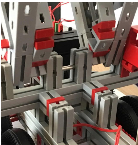
Abb. 5: Abstützung Träger auf Fahrgestell
