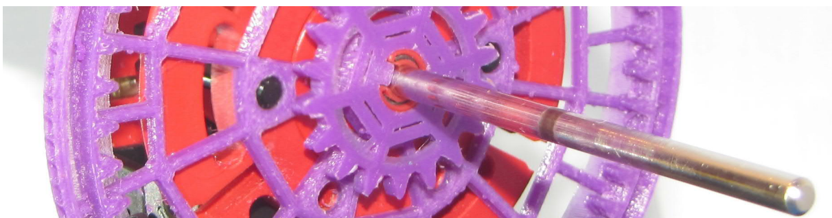
Abb. 6: Das eingebaute Hohlrad 1B54 mit 1A18
