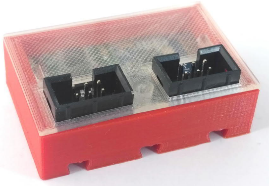
Abb. 6: ftduino-Bluetooth-Adapter in 3D-gedrucktem Gehäuse
