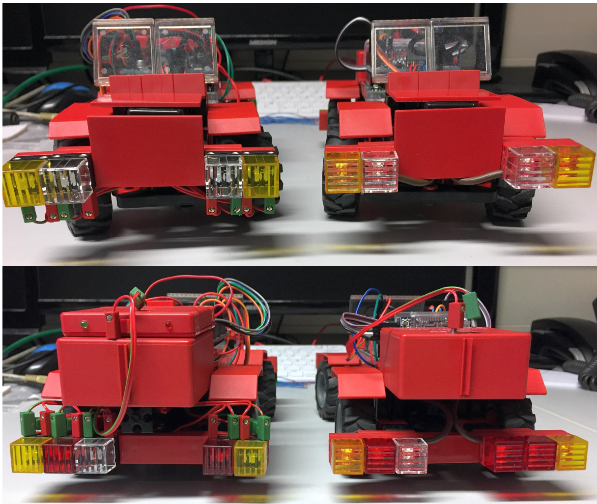
Abb. 6: Original-Flitzer (links) und steckerfreie Version (rechts) [1]
