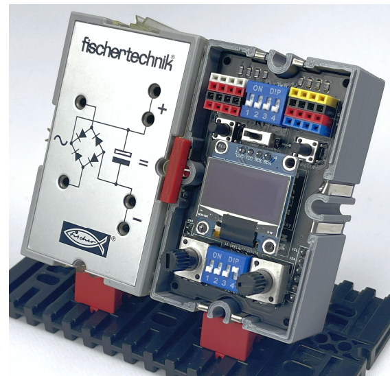
Abb. 9: Geöffneter Zauberling mit Gleichrichter
