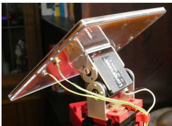
Abb. 4: Longrunner-Servo für die Höhenwinkel-Verstellung (0-180 Grad) mit aufmontiertem 3-Volt-ETM500-Solarpanel
